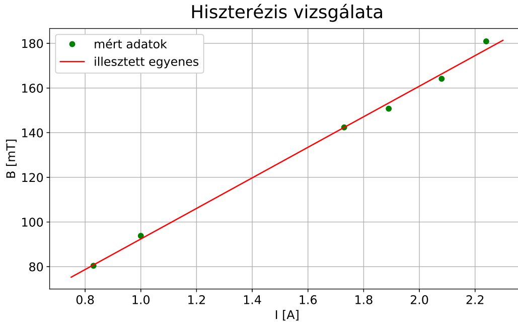
2. ábra. A mért mágneses tér nagysága az elektromágnesen átfolyó áram függvényében
